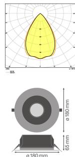
**Caractéristiques Ledvance Spot encastrable LED Performance DN155 14W 1500lm 65D - 830 | 180mm - IP54**
