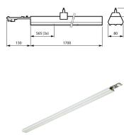
Technische Daten Philips LED Tragschiene Coreline
