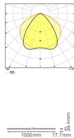
**Technische Daten Ledvance LED Tragschiene Trusys Flex Klar Stahl Weiß 50W 8600lm 90D - 840 Kaltweiß | 3 Stunden Notbeleuchtung**
