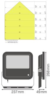
**Technische Daten Ledvance LED-Scheinwerfer Photocell GEN 3 Schwarz 65W 8000lm 100D - 840 | IP65 - Lichtsensor - Symmetrisch**
